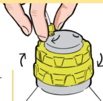
Setzen Sie die bestückte b.safe Cap auf die Eluentenflasche und drehen Sie sie fest. Wenn die Fritte den Flaschenboden berührt, drehen Sie auch das b.safe Fitting fest; ansonsten erst Kapillare nachschieben.
